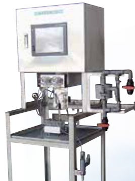
フローインジェクション方式による連続滴定測定 Continuous titration system by flow injection method
