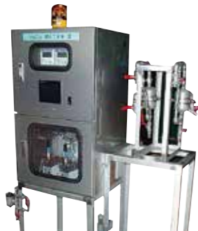
各製造工程での滴定による濃度測定 Concentration measurement by titration for manufacturing process
